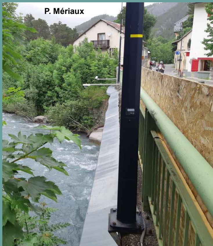
Capteur (radar) de hauteur d'écoulement
